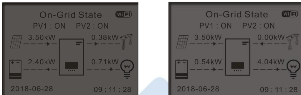
Abbildung 40 - Inverteranzeige im Modus Eigenverbrauch (2)
