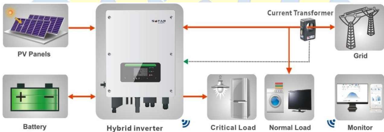
Abbildung 1 - Schematisches Diagramm einer Anlage mit einem Hybridinverter HYD 10-20KTL-3PH
